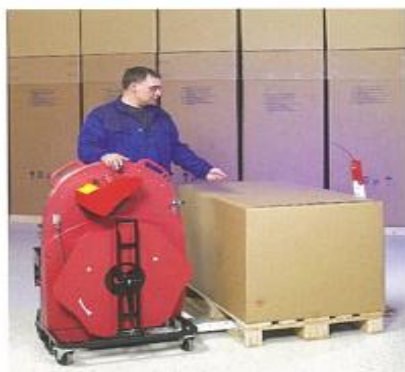
②ジョイスティックを操作しチェーンをパレット下に通す。
